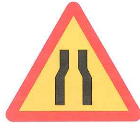
Đường bị thu hẹp hai bên
