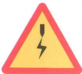
Đường cáp điện phía trên
